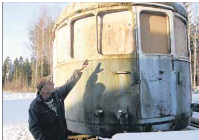
Rikotut ikkunat on peitetty vanerilevyin.
